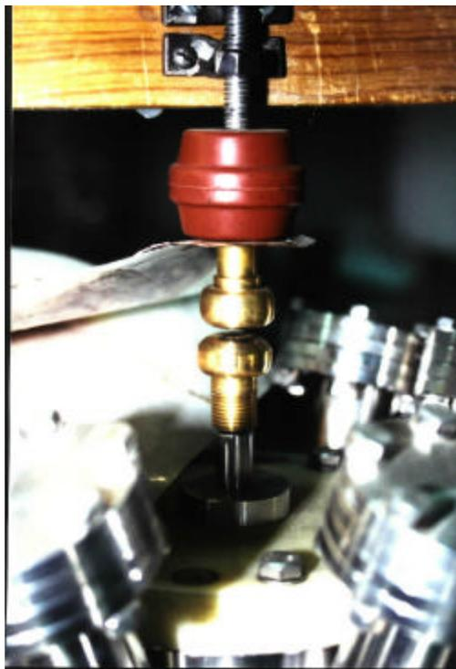
Figura 3.16 Aspecto físico de *spark-gap* de desacoplo. (Electrodos de latón).
