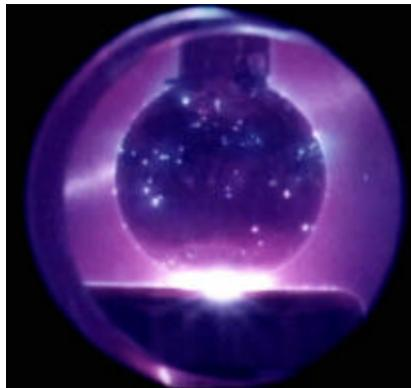
*Figura 5.13 Pulso de  $40\text{ kV}$  aplicado a una configuración esfera-plano a  $10^{-6}\text{ mbar}$ .*
